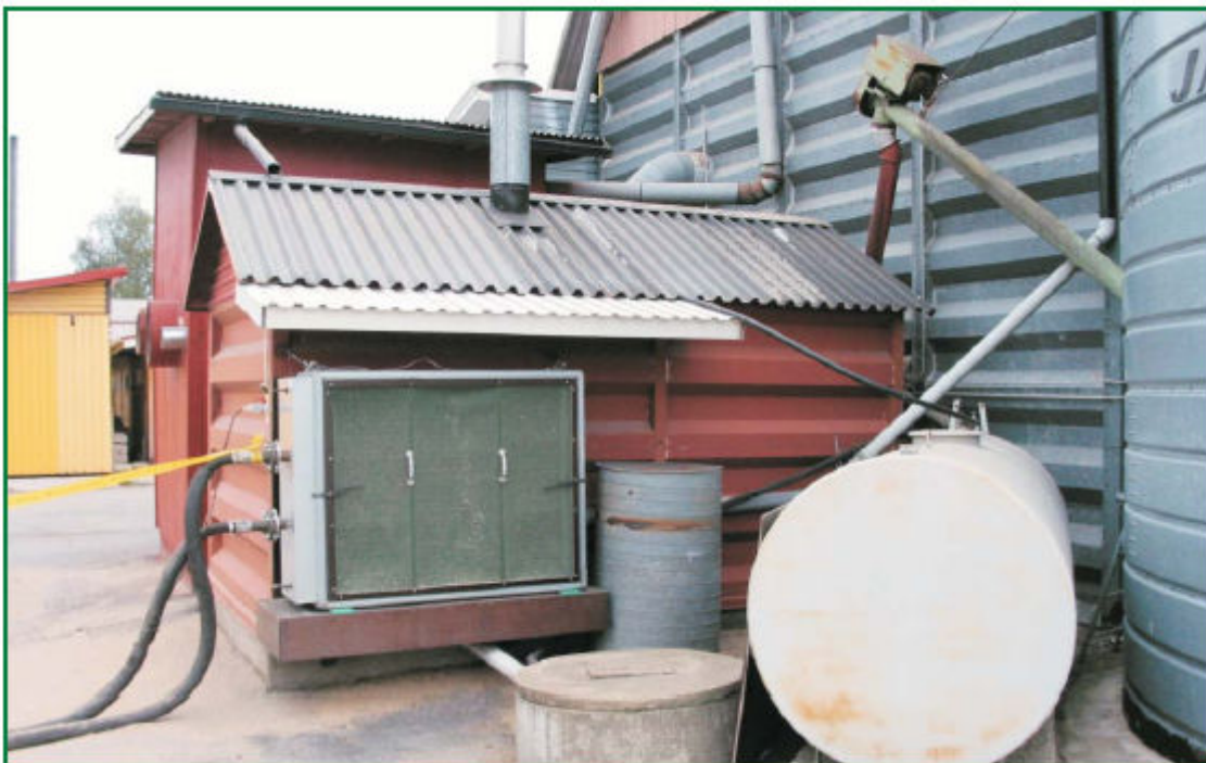
Bild 12. Radiatorn placeras framför fläktens sugöppning.
